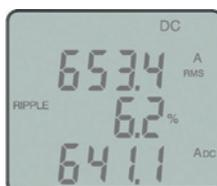
Il **RIPPLE** è un parametro che permette di quantificare la qualità dell'**ondulazione residua della corrente continua**, che deve essere il più piccolo possibile.
