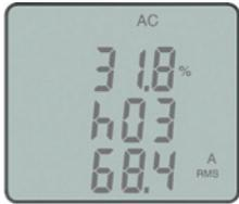
Le armoniche di **3° grado** e **suoi** multipli sono generalmente dovute a **carichi con alimentazioni raddrizzate** (circuiti elettronici, gruppi di continuità) o ad alcuni sistemi d'illuminazione.
