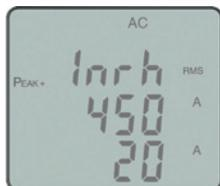
La conoscenza della corrente di **spunto** è indispensabile al dimensionamento di un impianto elettrico (interruttore principale, relè, fusibili ...). Infatti, questa corrente può **arrivare** a 20 volte la corrente nominale, **quindi** si richiede l'utilizzo di dispositivi di protezione **dimensionati**.
