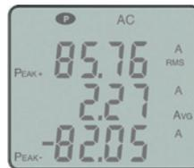
Le misure **Min/Max** sono utili per l'**analisi** delle variazioni dei valori misurati e **per monitorare** le fluttuazioni della misura.
