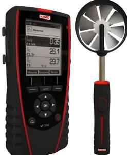
**VT210 + sonda SH100** (sonda a elica Ø100 mm per velocità, portata e temperatura)
