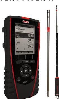
**VT210 + sonda SFC300** (sonda multifunzione per velocità, portata e temperatura)
