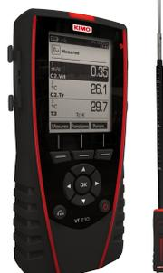
**VT210 + sonda SMT 900** (sonda multifunzione telescopica per velocità, umidità relativa e temperatura)
